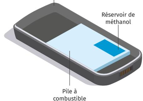
Le méthanol, un combustible liquide, est contenu dans un réservoir de plastique
