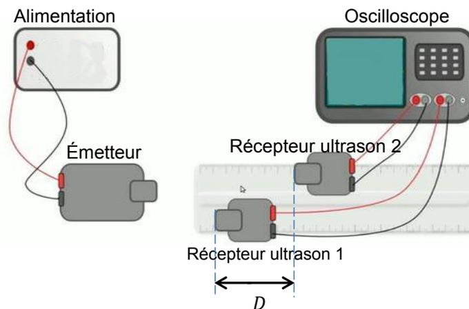
Les signaux enregistrés sont observés sur le chronogramme ci-dessous. La distance entre les deux récepteurs est  $D = 18,1 \text{ cm}$ . La base de temps de l'oscilloscope est réglée sur  $100 \mu\text{s}/\text{div}$ .
