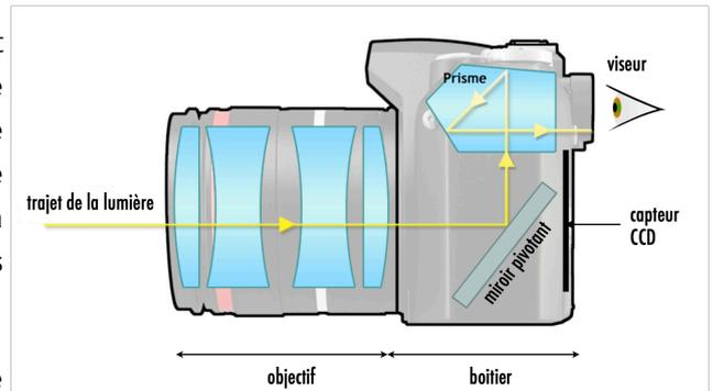
Pour simplifier, l'objectif peut être modélisé par une lentille mince convergente unique, dont la distance focale est égale à celle de l'objectif. Les distances sont donc exprimées par rapport au centre optique de cette lentille.
