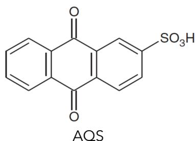
Les réactions au sein de la cellule électrochimique mettent en jeu les couples oxydant-réducteur BQDS /  $H_2BQDS$  et AQS /  $H_2AQS$ , espèces présentes en solution aqueuse dans les réservoirs de stockage.
